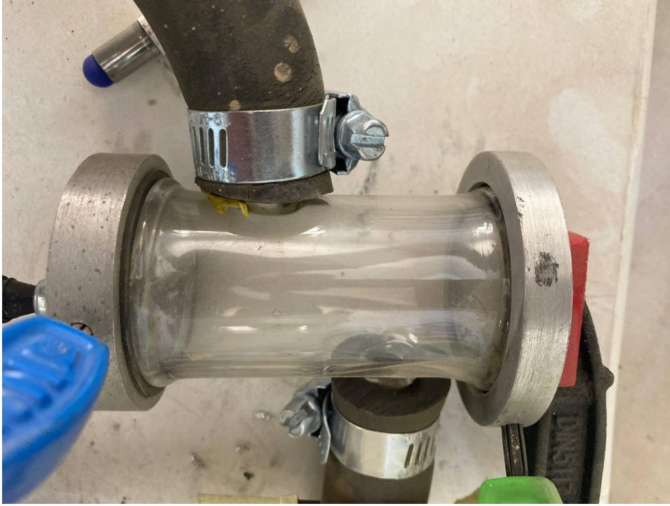
الشكل 2: أقطاب الالمنيوم المستخدمة لتوليد البلازما
