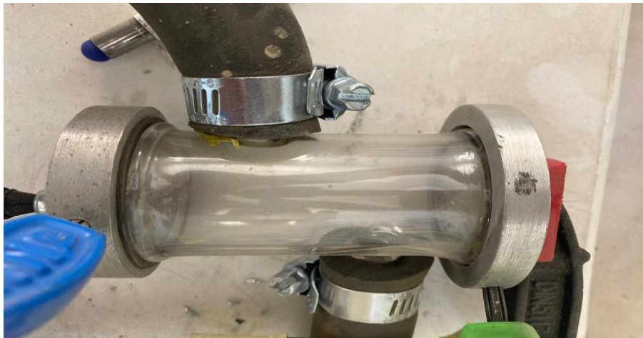
الشكل 2: أقطاب الالمنيوم المستخدمة لتوليد البلازما
