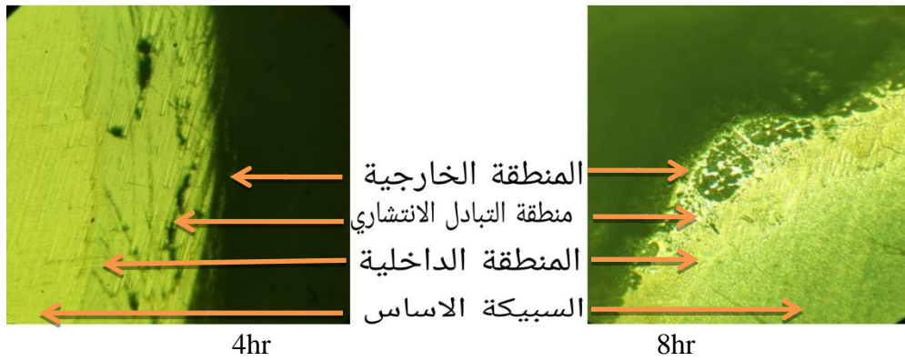
الشكل 5: التركيب المجهرى للطلاء الناتج بوجود الحازر الحراري ايتريوم \text{Y}_2\text{O}_3 بدرجة حرارة 1000\text{C}^\circ للمُدَد الزمنية 4hr ؛ 8hr
